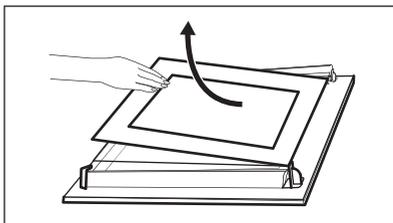
**Paso 8** Limpie los paneles de cristal con agua y jabón. Seque cuidadosamente los paneles de cristal con cuidado. No limpie los paneles de cristal en el lavavajillas.
