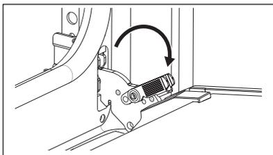
**Pas 3** Tanqueu la porta del forn a mig camí fins a la primera posició d'obertura. Després aixequu i tireu per retirar la porta del suport.
