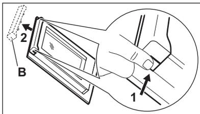
**Passo 7** Segure nas extremidades superiores dos painéis de vidro da porta e puxe-os para fora, um de cada vez, com cuidado. Comece pelo painel superior. Certifique-se de que o vidro desliza totalmente para fora dos suportes.
