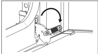
**Paso 3** Cierre la puerta del horno hasta la primera posición de apertura (a mitad de camino). A continuación, levanta y tira de la puerta para extraerla de su sitio.
