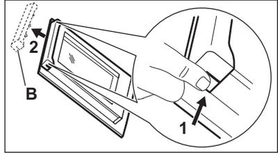
**Stap 7** Houd de glasplaten van de deur bij de bovenkant vast en trek ze er voorzichtig een voor een uit. Begin bij de bovenste plaat. Zorg dat het glas volledig uit de geleiders schuift.
