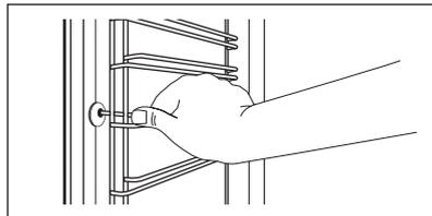
**Passo 3** Puxe a parte de trás do apoio para prateleiras para fora da parede lateral e retire-o.
