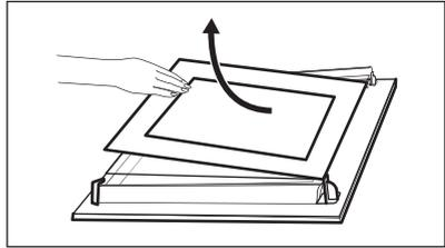
**Stap 8** Reinig de glasplaten met een sopje. Droog de glazen panelen zorgvuldig. Reinig de glasplaten niet in de vaatwasser.
