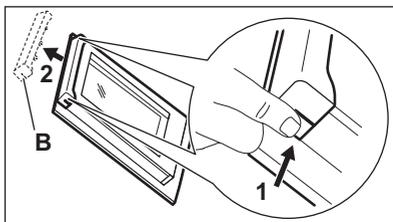
**Paso 6** Tire del borde del acabado de la puerta hacia delante para desengancharla.
