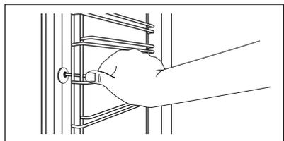
**Schritt 3** Ziehen Sie das Einhängegitter hinten von der Seitenwand weg und nehmen Sie es heraus.
