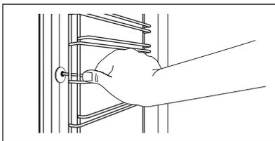
**Paso 3** Tire del extremo trasero del carril de apoyo para separarlo de la pared y extráigalo.
