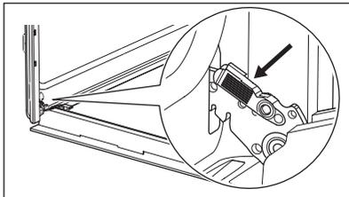
**Schritt 2** Heben und ziehen Sie die Verriegelungen an, bis sie einrasten.
