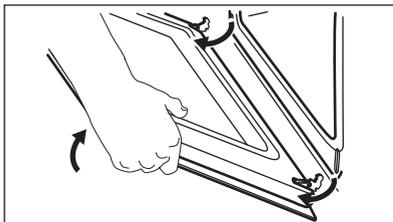
**Passo 5** Segure no friso da porta (B) no rebordo superior da porta, nos dois lados, e pressione para dentro para soltar o fecho de encaixe.
