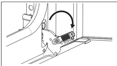
**Passo 3** Fechar a porta do forno até à primeira posição de abertura (a meio). Depois, levante e puxe a porta e retire-a dos encaixes.
