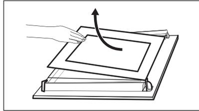
**Schritt 8** Reinigen Sie die Glasscheiben mit Wasser und Spülmittel. Trocknen Sie die Glasscheiben sorgfältig. Reinigen Sie die Glasscheiben nicht im Geschirrspüler.
