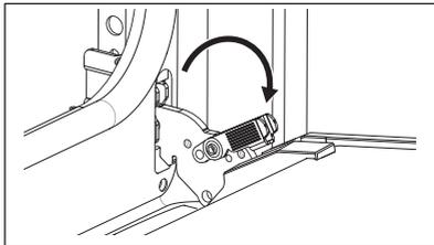
**Schritt 3** Schließen Sie die Backofentür halb bis zur ersten Öffnungsstellung. Anschließend heben und ziehen Sie die Tür aus der Aufnahme heraus.
